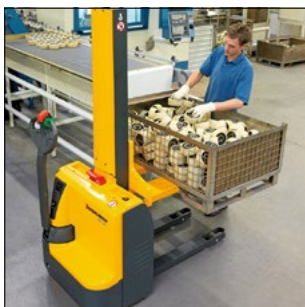
EMC zastosowany jako stół roboczy
