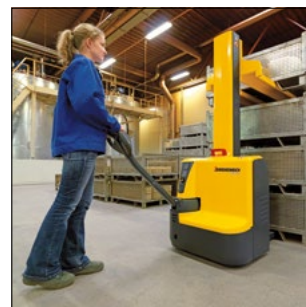
EMC zastosowany jako zwykły wózek podnośnikowy
